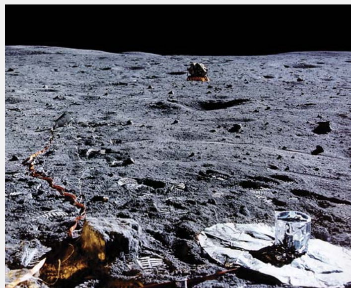
Снимок лунного сейсмометра, установленного astronautами на поверхности Луны. Снимок сделан экипажем Apollo 16, NASA.
